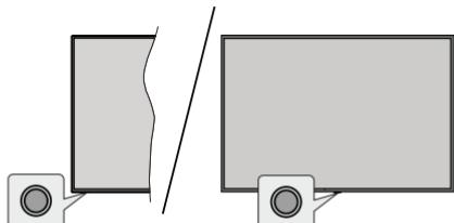
Med bruk av kontrollknappen kan du kontrollere TV-ens Hurtig ventemodus-funksjonen.
