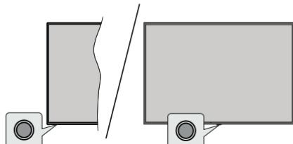
Кнопка управления позволяет управлять функцией включения режима быстрого ожидания телевизора.
