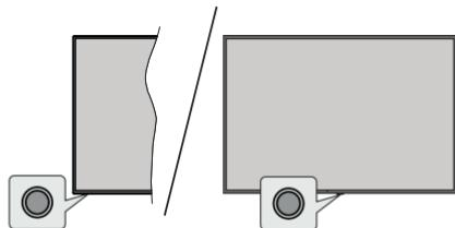
Med kontrollknappen kan du styra TV:ns snabbt vänteläge-På funktion.
